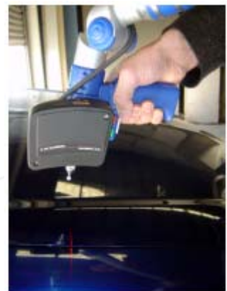
图2：安装在FaroArm上的ModelMaker Z70扫描头
