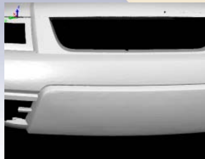
4. 网格化贝塞尔曲面，形成的三角面同周围的三角面平顺相接。
