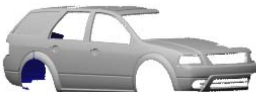
网格化扫描点云后的初始三角化模型
