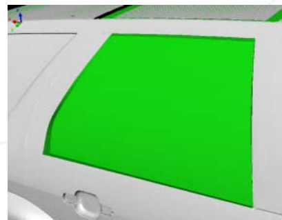
4. 网格化曲面同周围三角面连接。模型达到致密。
